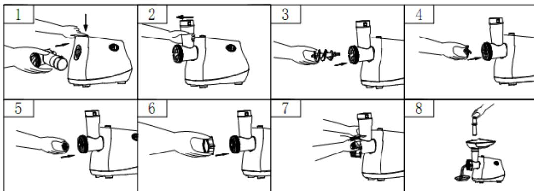
1. Tineti tubul si introduceti-l in mecanism cu o singura mana, impingeți cu cealalta mana si rotiti in sensul acelor de ceasornic pentru a-l fixa.[Pic 1]
